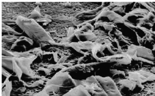
Рис. 5. Лучеобразные ячейки (фотография с электронного сканирующего микроскопа, увеличение 750 раз [8])
