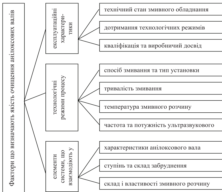
Класифікація факторів, що визначають якість процесу очищення анілоксових валів флексографічних друкарських машин
