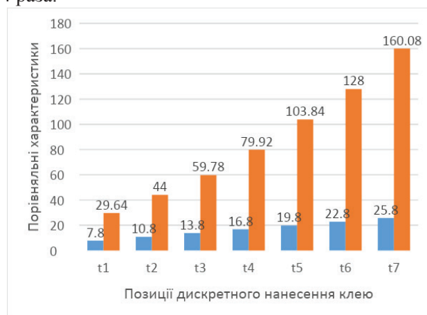
Рис. 4. Гістограма зміни площини перерізів дельтоподібних ділянок міжзошитового простору в процесі зміни товщини клейового шару
