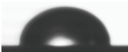
Рис. 2. Профілі краплин дистильованої води на поверхні фотополімерної форми: а) — до друкування тиражу; б) — після друкування тиражу
