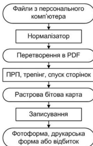
Рис. 9. Комбіноване PDF/PostScript 3 опрацювання потоку цифрових даних
