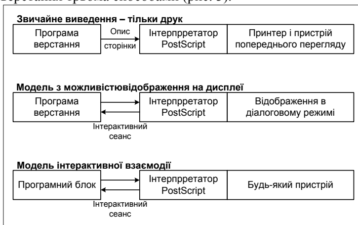
Рис. 3. Взаємодія між інтерпретатором PostScript та програмним додатком
