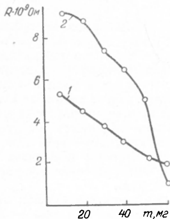
Рис. 1. Графік залежності електричного опору від кількості домішки металічного порошку:
