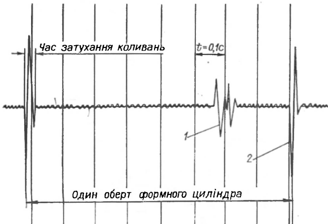
Рис. 3. Типова осцилограма коливань накатного валика.
