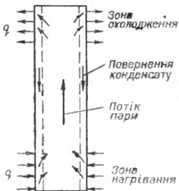
Рис. 3. Схема вихрового парогенератора. Рис. 4. Схема дії теплової труби.
