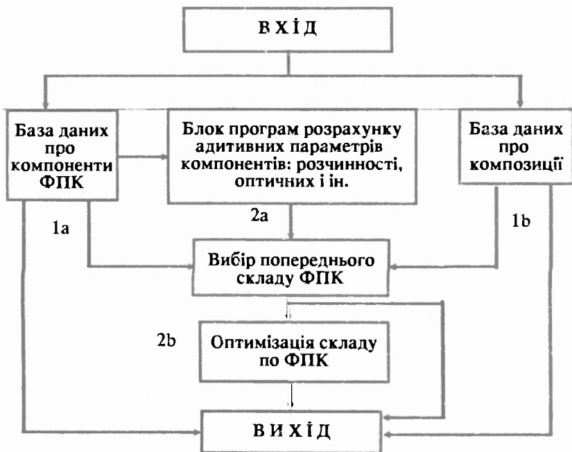
Рис. 3. Блок-схема автоматизованої системи комп'ютерного синтезу фотополімеризаційчоздатних композицій.
