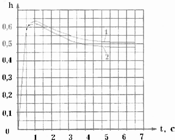
Рис. 2. Перехідні функції вихідної (1) і редукованої (2) моделей прикладу
