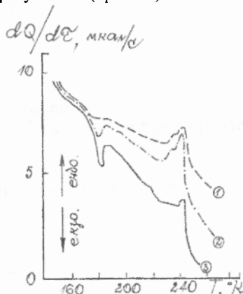
Рис. 3. Термограми для еластомера СКТВ-1 (1), обробленого в плазмі в атмосфері аргону (2) і повітря (3)
