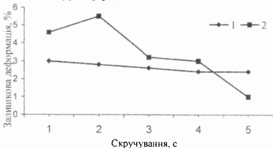
Рис. 4. Залежність між скручуванням і залишковою деформацією для колєнкору: 1 – поздовжній напрям; 2 – поперечний напрям
