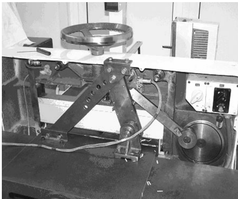
Рис. 1. Конструкция привода ножа-динамометра лабораторной установки
