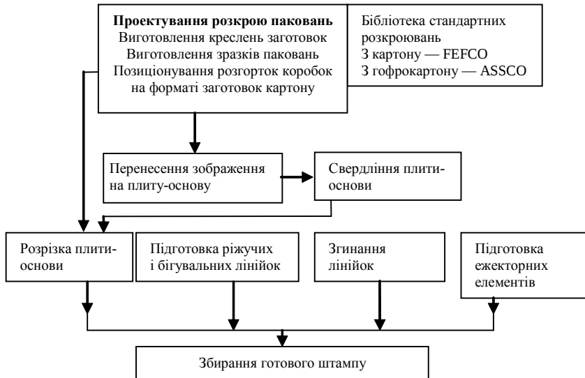
Рис. 2. Базова схема технологічного процесу виготовлення складного картонного пакування
