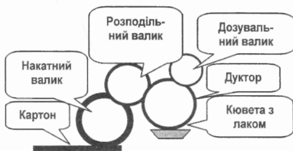
Принципова схема пристрою для нанесення лаків
